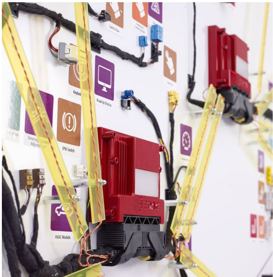
BILD 5 Zonencontroller, ausgestellt auf der IAA 2017 (© Edag)
