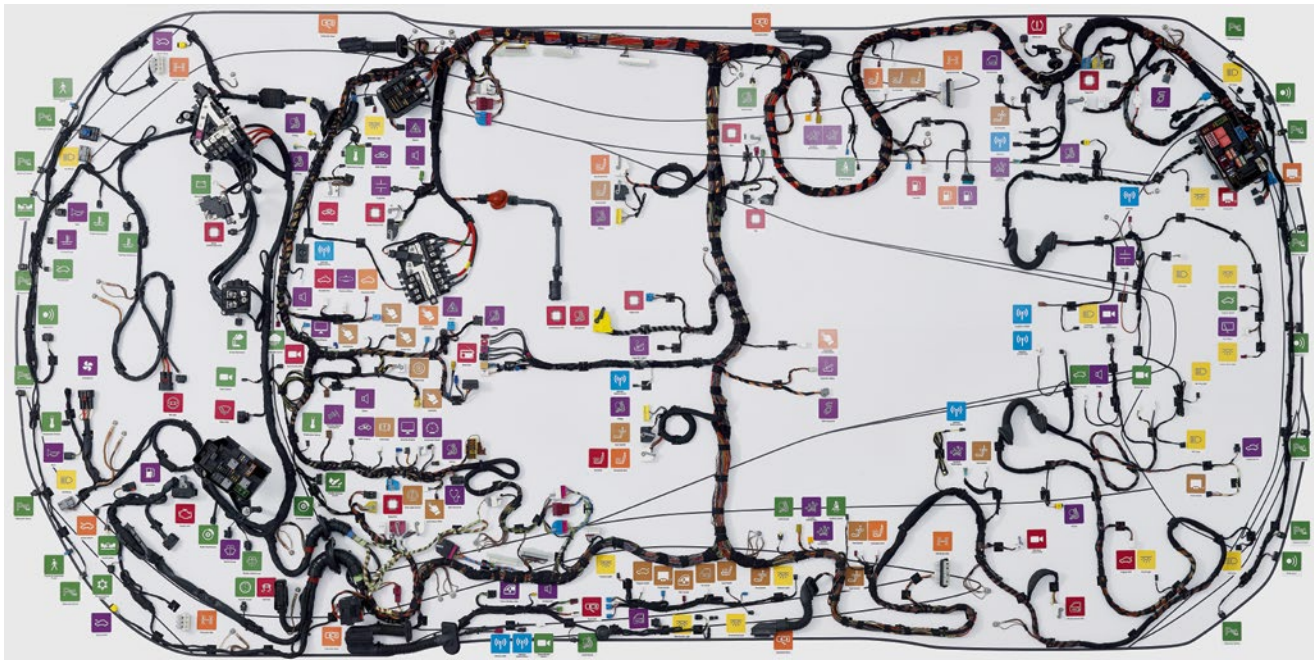
BILD 1 Bordnetz einer heutigen EE-Architektur (© Edag)
